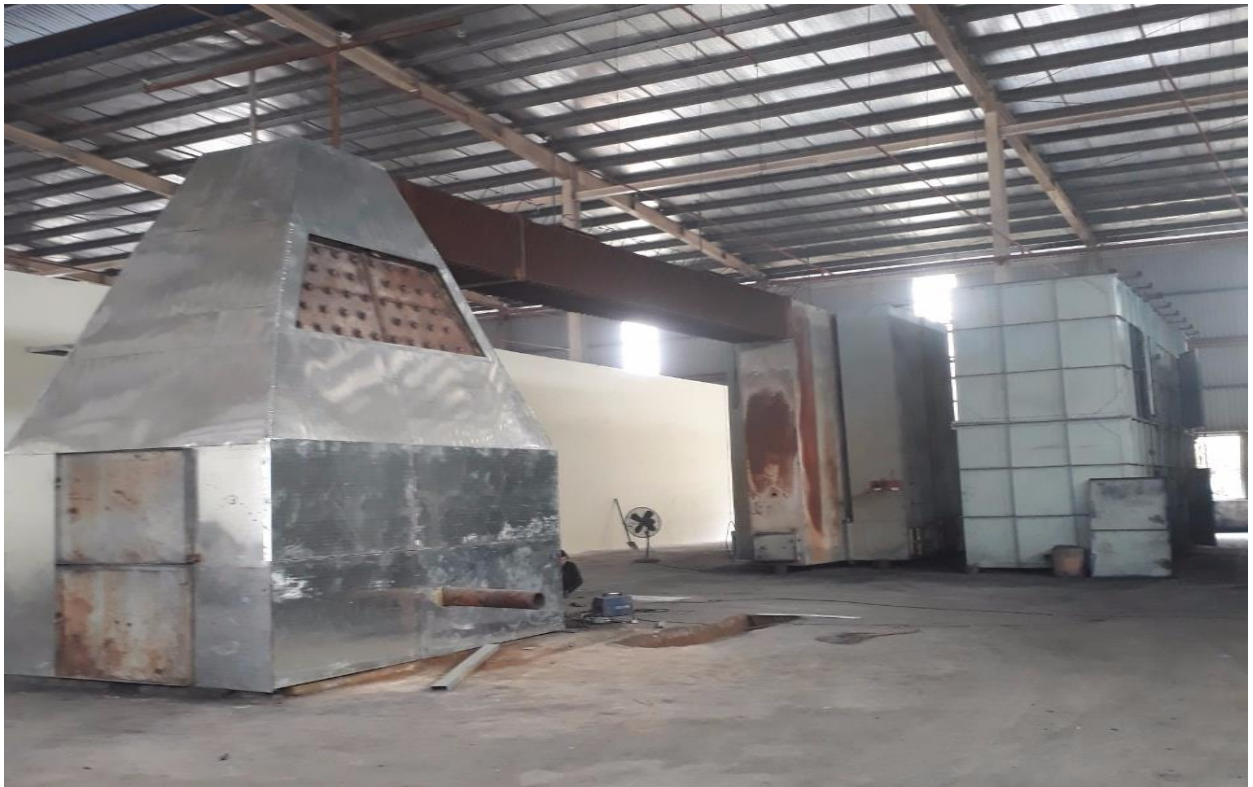
Lò nấu chì (hệ thống tái chế ắc quy chì)
